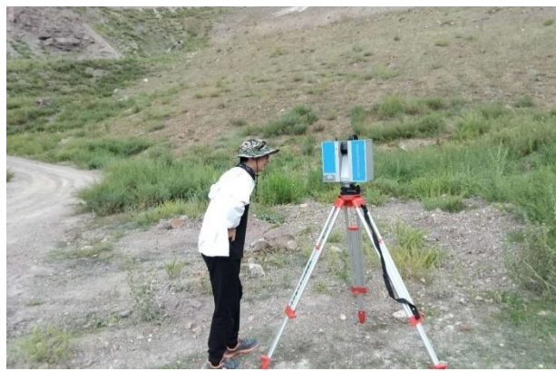
三维点云设备架设调试
